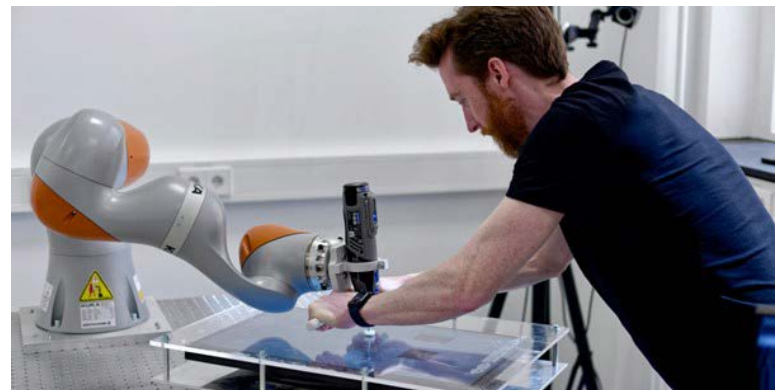
Afbeelding 4. De gecontroleerde labopstelling, waarmee op een reproduceerbare manier empirisch onderzoek gedaan kan worden om zo robotondersteuning in fysieke mens-robot-interactie te ontwerpen die de ervaring van de werknemer ondersteunt.
