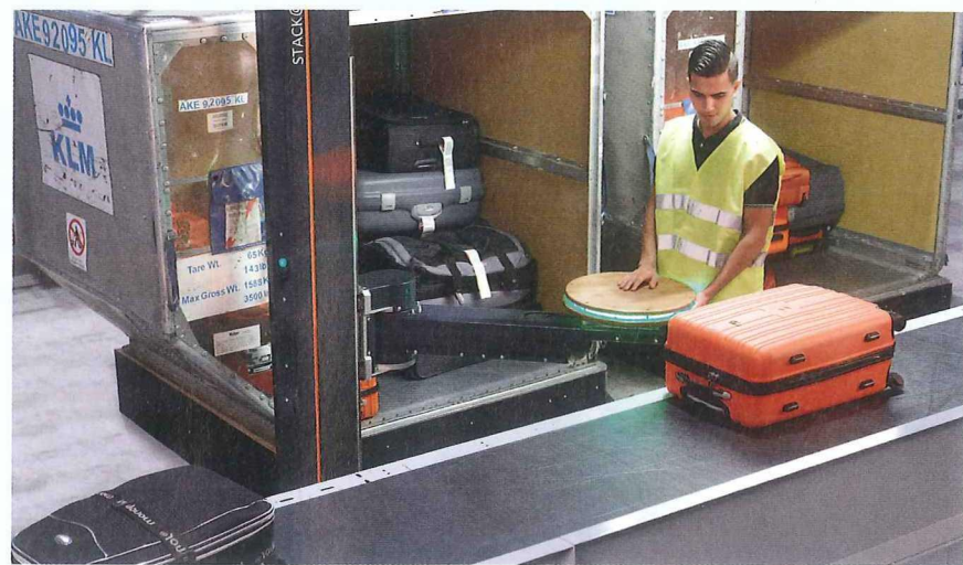
Met de stack@ease kan de operator koffers met minimale kracht optillen en verplaatsen.
