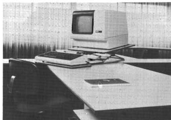
Een 'normaal' bureau met terminal plateau-programma. Verstelbaar in hoogte, neigbaar, draaibaar en uitschuifbaar (Ahrend)
