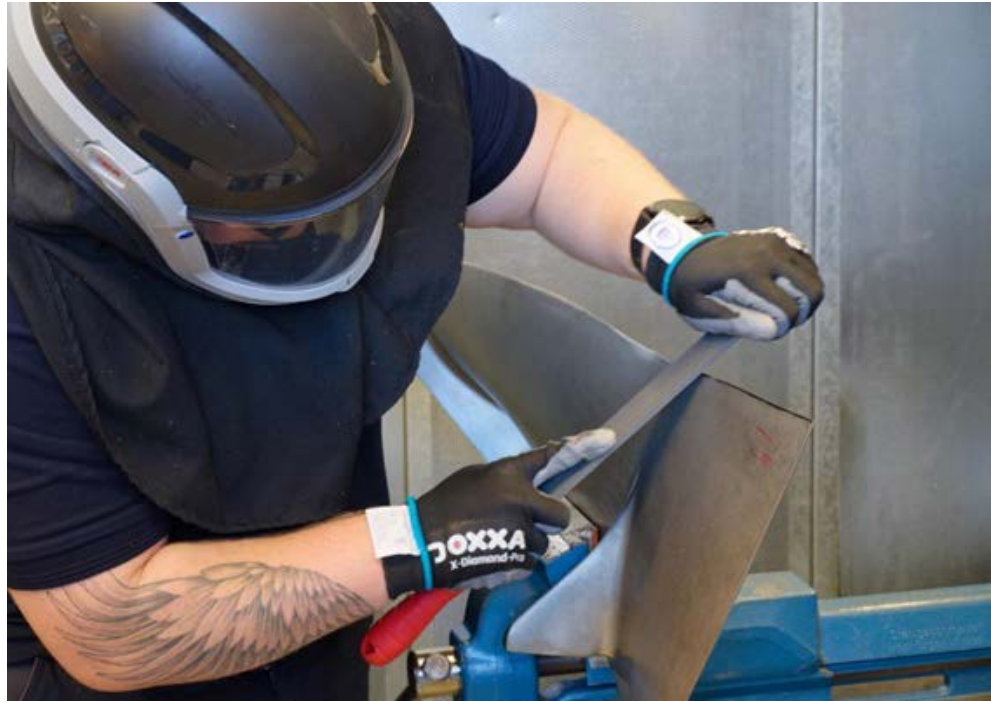
Afbeelding 1. Een illustratie van een deel van het huidige werkproces om titanium rotorbladen te repareren: het slijpen is fysiek zwaar werk dat vakmanschap vereist.
