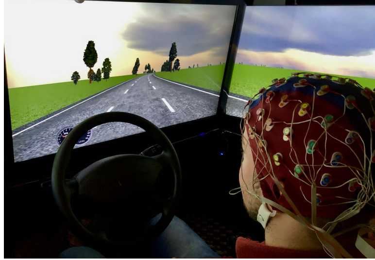
Afbeelding 1. Set-up waarin ontvankelijkheid van het brein voor alarmen wordt getest. Foto uit Van der Heiden et al., 2022. Overgenomen met toestemming.
