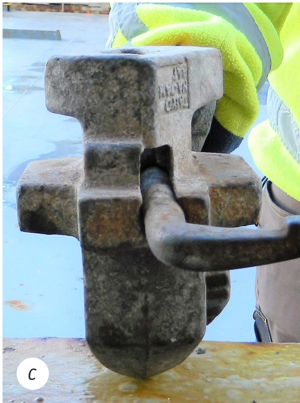
Afbeelding 1. Verschillende typen twistlocks: A. met twee touwtjes voor ontgrendeling; B. met één touwtje (twee versies: met kort/dik en dun/lang touwtje); C. met draaivergrendeling; D. semi-automatisch.
