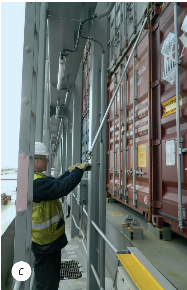
Afbeelding 2. Typische houding bij het sjorren: A. met een lange stok; B. met een korte stok; C. metingen van de krachtoefening bij lostrekken van de twistlocks.
