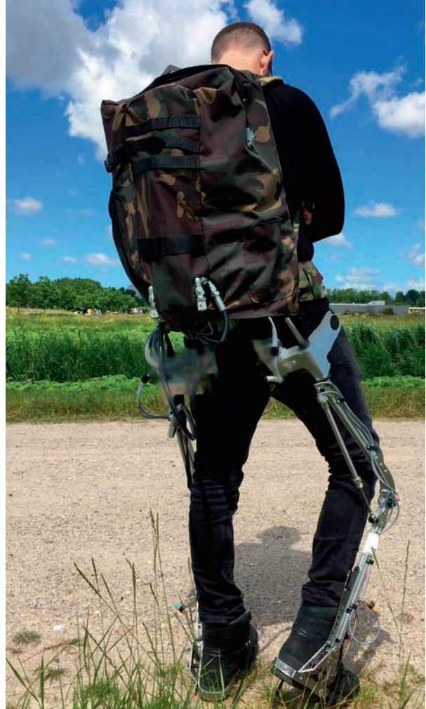
Afbeelding 2. Een militaire toepassing van een exoskelet: de zogenaamde ExoBuddy, een exoskelet die het lopen met zware bepakkings ondersteunt, in ontwikkeling bij TNO en Intespring.
