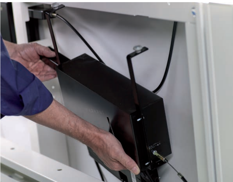
Afbeelding 6a en 6b. Eenvoudig achteraf inbouwen motor voor hoogteverstelling.
